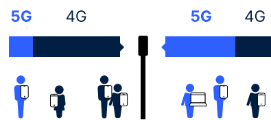
Abbildung 5: Beispielhafte Bandbreitenaufteilung mit Dynamic Spectrum Sharing (DSS)
