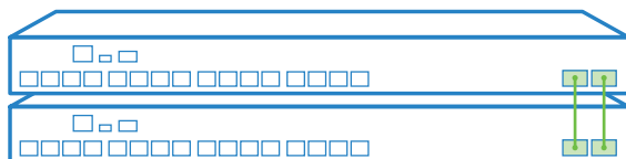
Abb. 15: Darstellung der Verkabelung eines 2er-Stacks beim XS-5116QF
