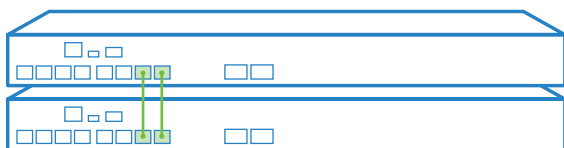
Abb. 14: Darstellung der Verkabelung eines 2er-Stacks beim XS-5110F
