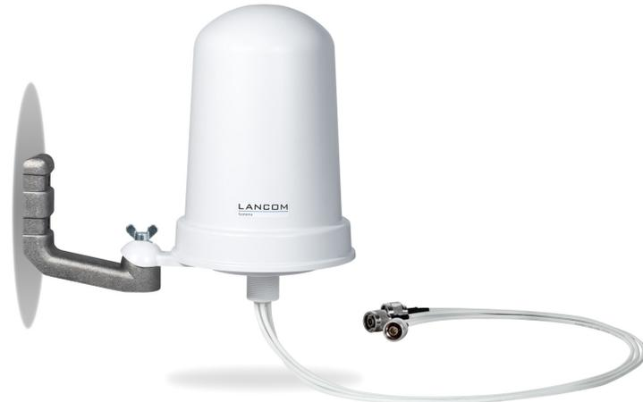
Die wetterfeste LANCOM Rundstrahlantenne AirLancer ON-T360ag bietet die Möglichkeit, effektiv eine große Fläche mit WLAN auszuleuchten. Zentral montiert eignet sie sich optimal für eine 360°-Abdeckung. Dank 3x3 MIMO-Unterstützung bietet sie höchste Leistung im WLAN-Standard IEEE 802.11ac mit bis zu 1.300 MBit/s. Zudem ist sie in Kombination mit Dual Radio Access Points für den Parallelbetrieb in 5 GHz mit 2x2 MIMO und 2,4 GHz mit 1x1 MIMO ideal geeignet.
