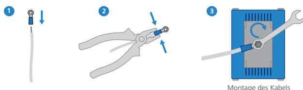
Der Potenzialausgleich erfolgt über die Gebäudeerdung mittels einer PE-Leitung (Protective Earth, Schutzleiter – min. 1,5 mm<sup>2</sup> Cu). Verbinden Sie den beigefügten Kabel-
