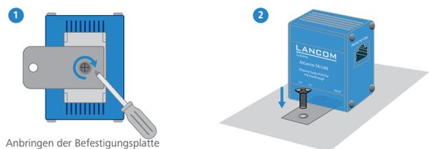
Verbinden Sie den Flansch mittels der beigefügten Senkkopfschraube mit dem Gehäuse des AirLancer SN-LAN. Achten Sie darauf, die gesenkte Bohrung des Flansches zu verwenden. Achten Sie auf eine feste Verbindung. Befestigen Sie den Flansch auf einer fachgerecht geerdeten metallischen Fläche.
