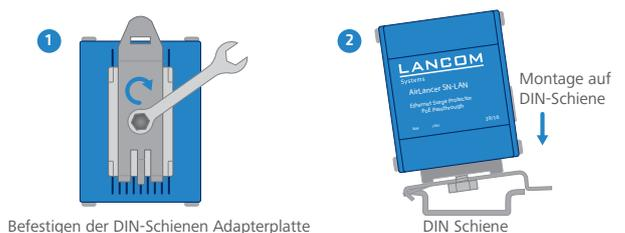
Verbinden Sie den DIN-Schienenadapter mithilfe der beigefügten Sechskantschraube plus Zahnscheibe mit dem Gehäuse des AirLancer SN-LAN. Achten Sie auf eine ausreichend feste Verbindung. Befestigen Sie den AirLancer SN-LAN auf der DIN-Schiene.
