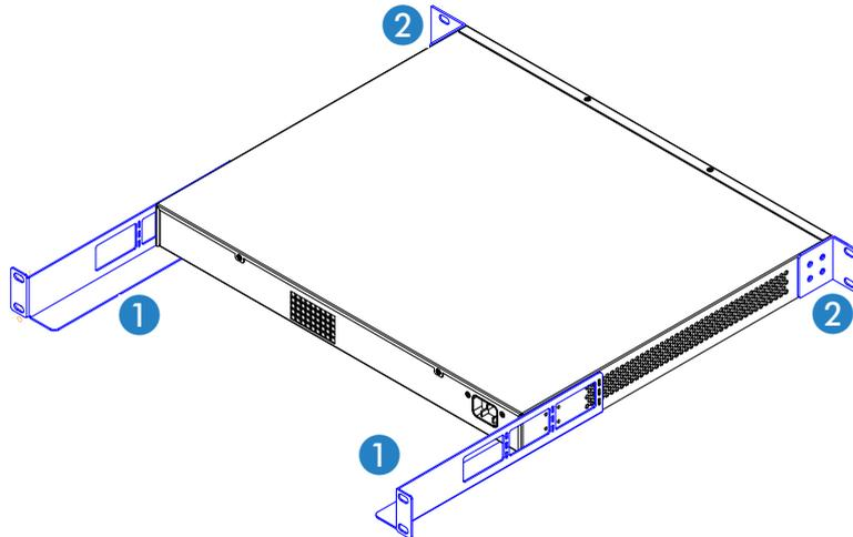
Beginnen Sie mit der Montage der beiden hinteren Auflageschienen **1**, indem Sie diese durch die Langlöcher mit jeweils 2 der 8 beiliegenden Rackbefestigungs-Schrauben von hinten im Rack befestigen.
