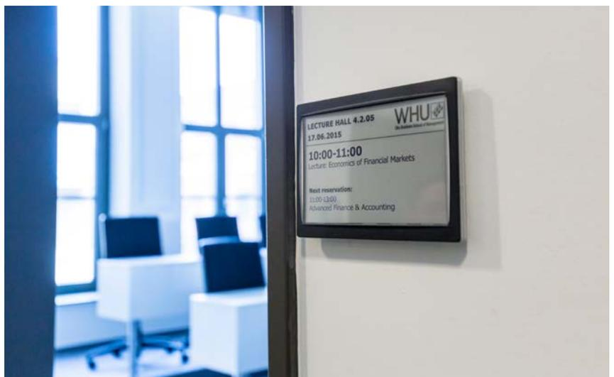
Raumbeschilderung: Die Displays werden über Access Points angesteuert, die gleichzeitig ein leistungsstarkes WLAN aufbauen. Sie ermöglichen in den Räumen und Fluren der Hochschule den drahtlosen Netzwerkzugang für die Studenten. „Interferenzen gibt es bei den Funksignalen keine. Alles arbeitet störungsfrei und stabil“, so Schneider.
